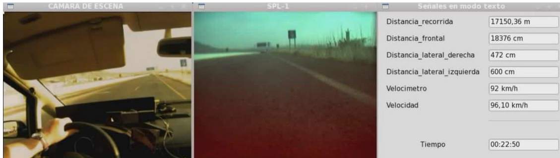
Figura 5-4. Empleo simultáneo del menú contextual que permitía vincular datos alfanuméricos e imágenes video. Fuente: INTRAS, 2014.
