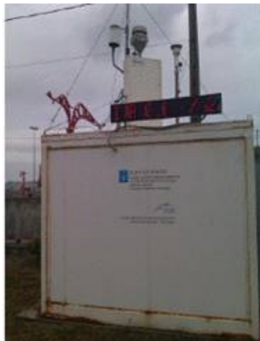
Figura14. Captador gravimétrico Digitel DH-80 en la estación de A Torre de Hércules (fondo urbano)
