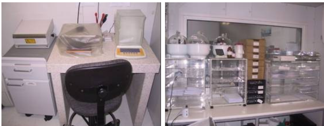
Figura 16. Interior de la sala de balanzas de las instalaciones del IUMA. Ubicación de la balanza analítica empleada y la lámpara UV para examinar los filtros
