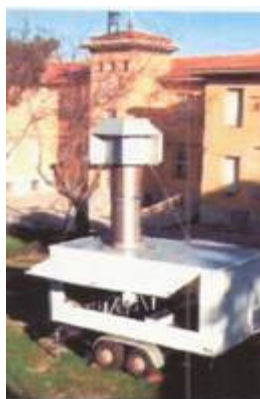
Figura 7. Sistemas de super alto volumen: captador WRAC ( Wide Range Aerosol Classifier )- PM 10
