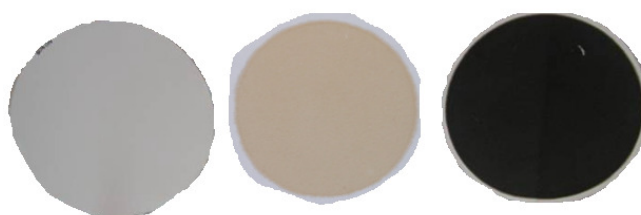
Figura 9. Filtro en blanco y filtros con diferentes tipos de material particulado atmosférico.
