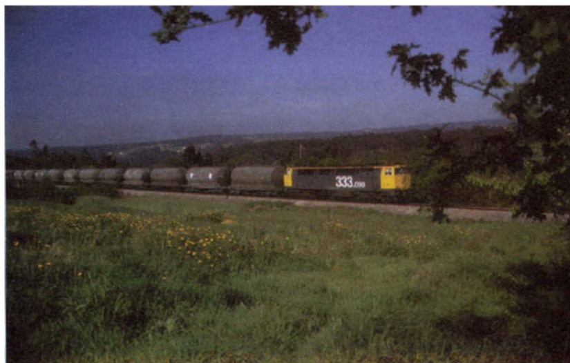
Locomotora 333.090 remolcando tolvas de cemento en la rampa de 18% entre Betanzos y Oza de los Ríos, en la línea La Coruña-Monforte (abril, 1995).
