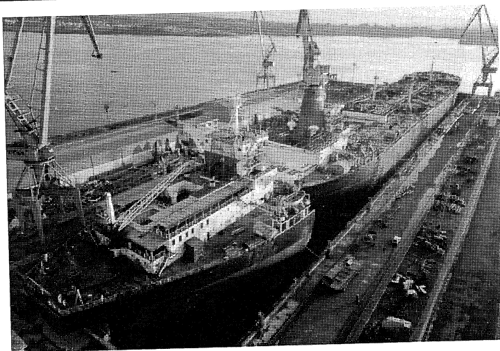
Foto 10.- Vista general del dique durante la fase de unión del petrolero.
