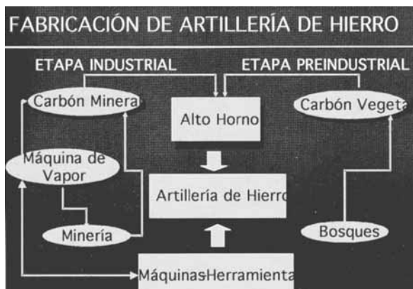
Figura 4. Esquema del proceso preindustrial y del industrial.
