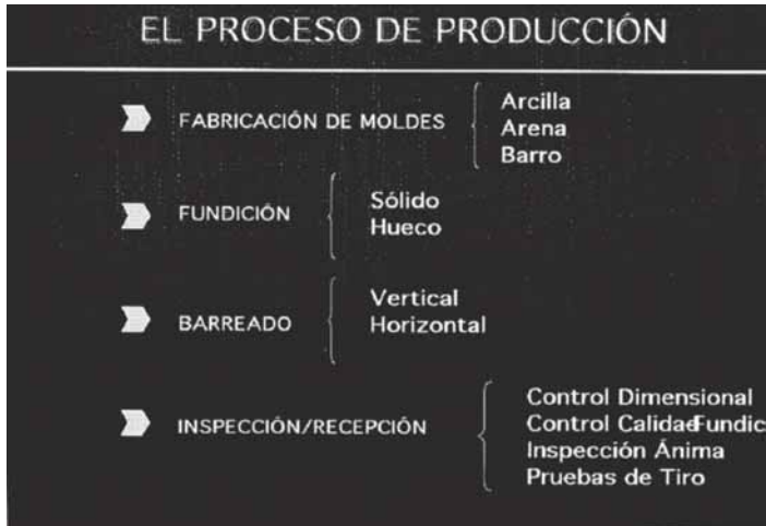
Figura 3. El proceso de producción de la artillería de hierro.
