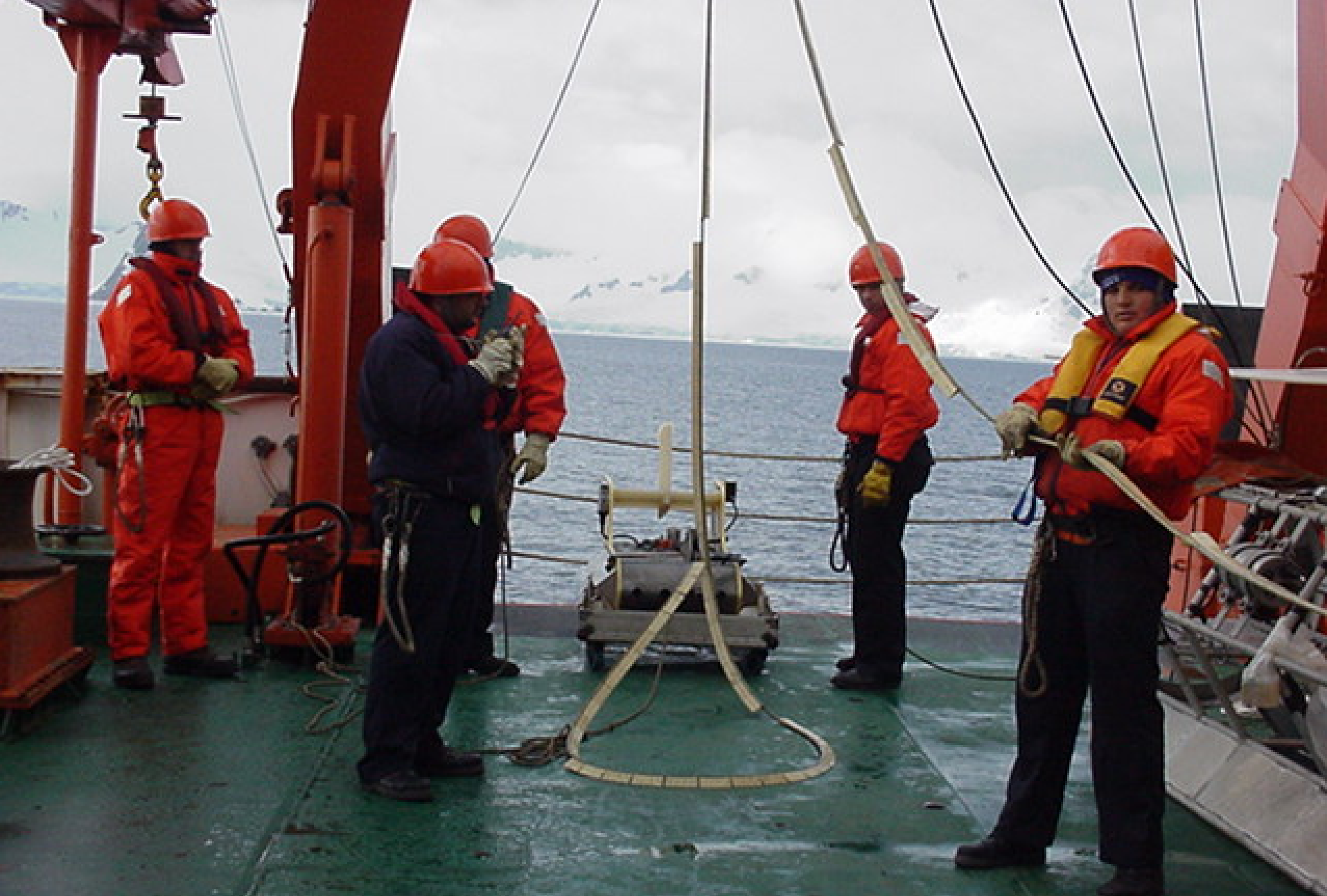
CTD remolcado medición datos hasta 150 m. profundidad
