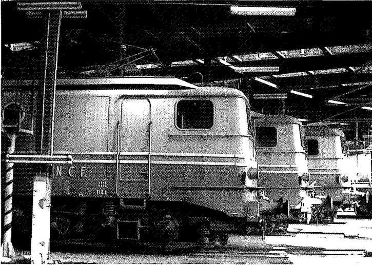
Figura 5. Locomotoras de la serie CC 7.100 en el depósito de Ambérieu. La locomotora CC 7.107 fue una de las protagonistas del récord mundial de 1955, al alcanzar 331 km/h en cabeza de un tren de ensayo.
