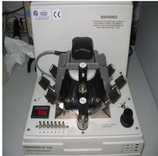
Figura 3.16. Medidor de permeabilidad al vapor de agua
