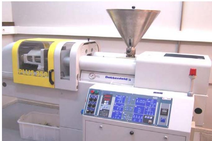
*Figura 3.5. Inyectora Battenfeld Plus 350*
