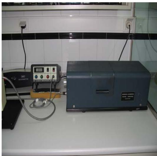
*Figura 3.15. Medidor de turbiedad*
