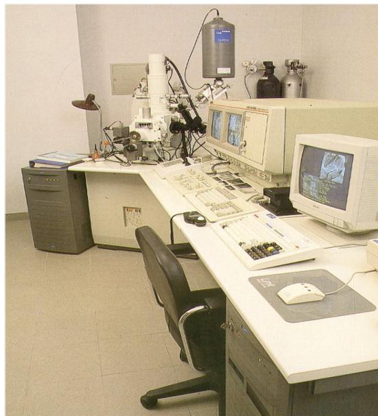
*Figura 3.12. Microscopio electrónico de barrido JEOL JSM-6400*
