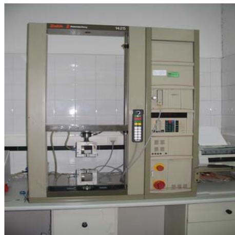
Figura 3.10. Máquina de ensayos Zwick 1425
