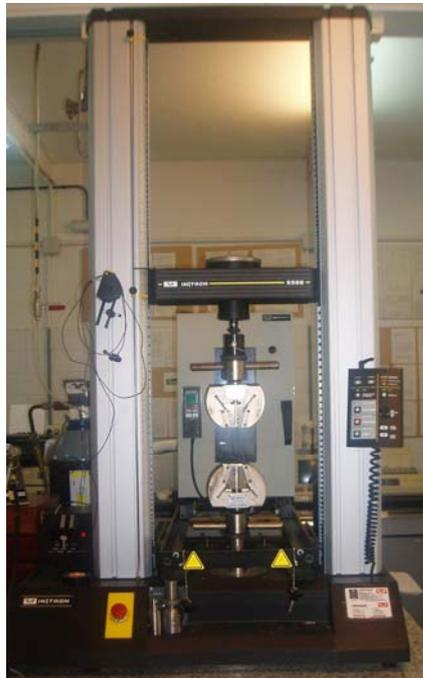
*Figura 3.9. Máquina de ensayos Instron 5566*
