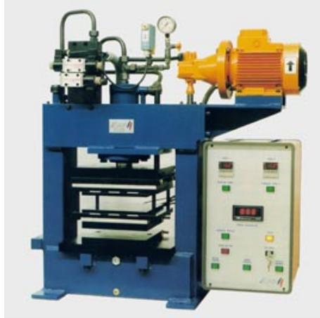
*Figura 3.6. Prensa IQAP-LAP de laboratorio PL-15*
