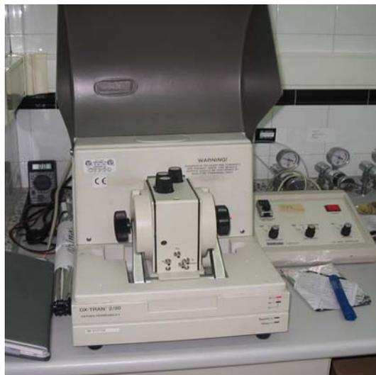
*Figura 3.18. Medidor de permeabilidad al oxígeno*
