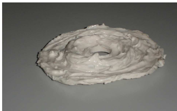
Fig. 101 Ensayo fabricación de membrana mediante adición de tixotrópico a la resina
