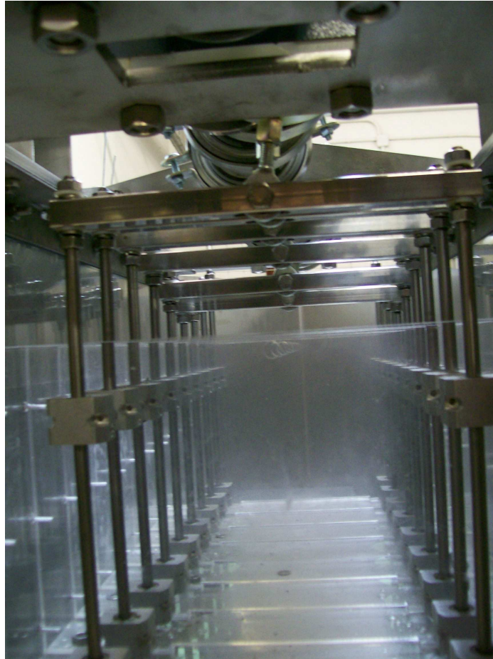
Fig. 95 Detalle del soportado de los rodamientos lineales
