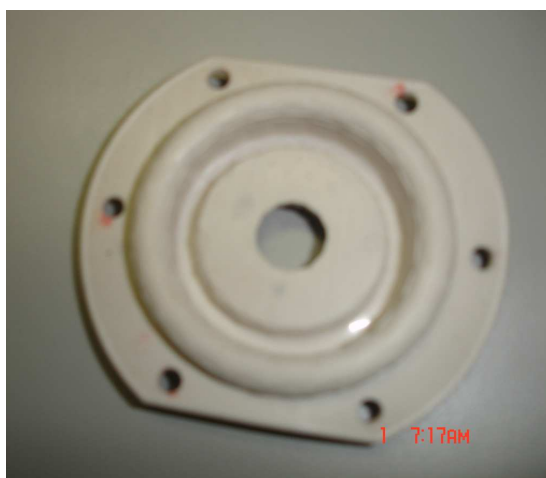
Fig. 106 Membrana perfectamente construida y ya troquelada
