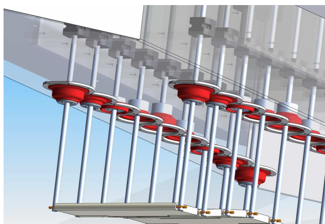
Fig. 99 Vástagos atravesando el casco
