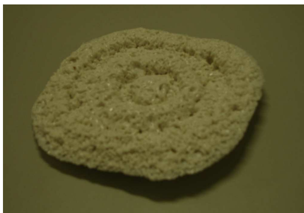
Fig. 107 Resina en mal estado sometida a vacío
