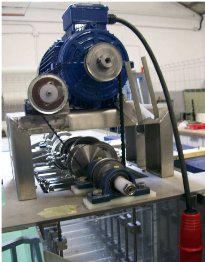
Fig. 93 Motor eléctrico y transmisión mecánica (prototipo construido)
