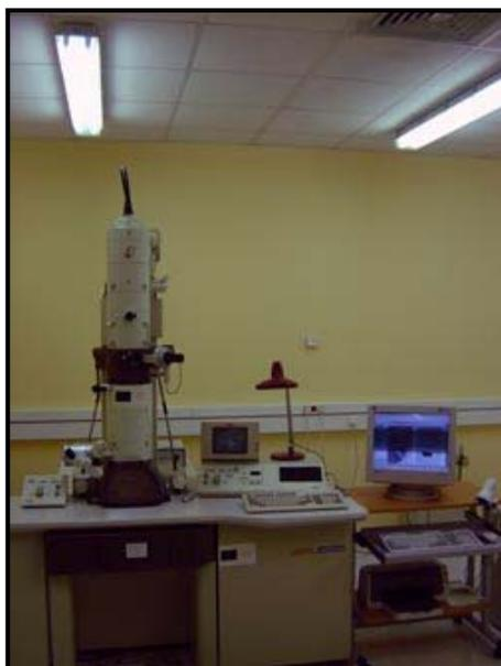
Figura 3.9. Microscopio electrónico de transmisión JEOL JEM-1010.
