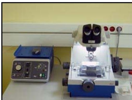
Figura 3.10. Ultramicrotomo LEICA AG REICHERT ULTRACUT E 701704.
