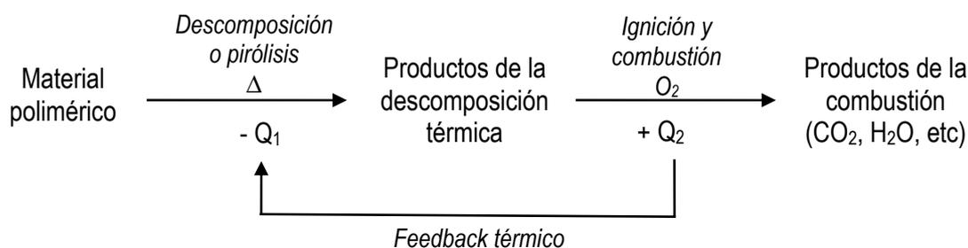
Esquema 6. 12. Mecanismo de combustión de los materiales poliméricos.
