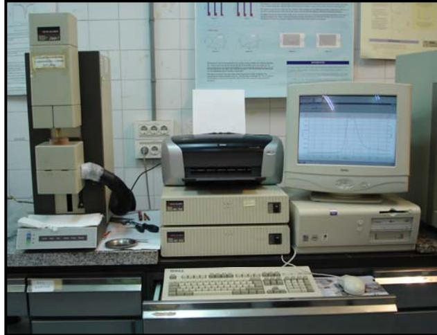
Figura 3.6. Analizador dinamomecánico de Perkin-Elmer.
