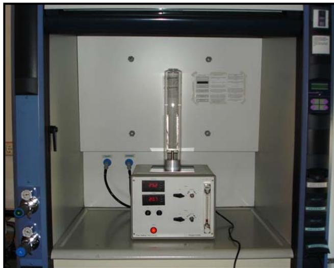
Figura 3.15. Equipo Stanton Redcroft para la determinación del LOI.
