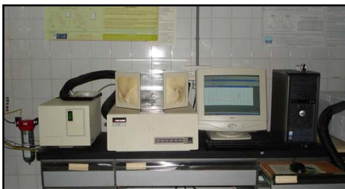
Figura 3.1. DSC 7 de Perkin Elmer.
