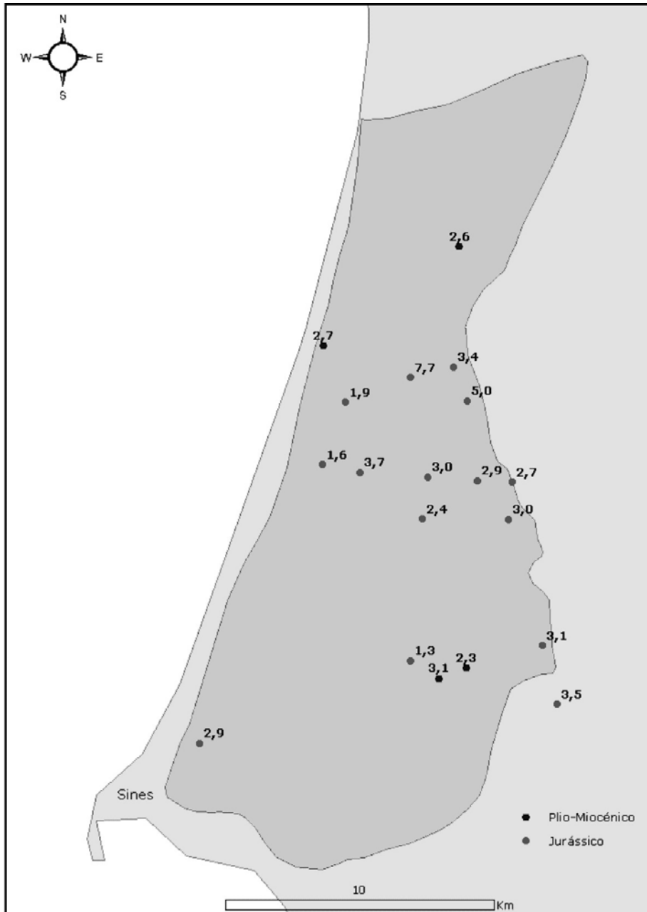
Fig. 7 – Distribuição espacial dos valores de ^3\text{H} (TU) no sistema aquífero da Bacia de Sines. Resultados obtidos nas análises das amostras de águas pertencentes ao Jurássico e Plio-Miocénico. O erro associado a cada determinação é \pm 0.6 TU (adaptado de Galego Fernandes, 2004).
