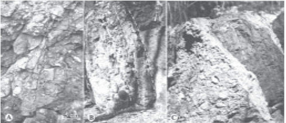
Fig. 17. Estruturas brechificadas que marcam o contacto entre as formações paleozóicas e neoproterozóicas na área estudada, onde foi possível identificar o registo da movimentação. Em A – fendas de tracção ( realçadas na figura por linhas auxiliares ); em B – laminação originada por superfícies de falha; em C – estrias ( tracedado ) em espelho de falha.
