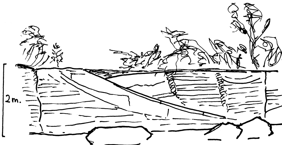
Fig. 3. Esquema de parte del frente de cantera de Mariz mostrando la distribución de fracturas que delimitan finas lajas de roca y cuñas imbricadas.
