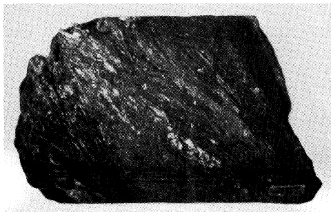
Fig. 11. Cataclastita rica en grafito, lo que intensifica la conductibilidad eléctrica (diámetro del testigo: unos 10 cm).
