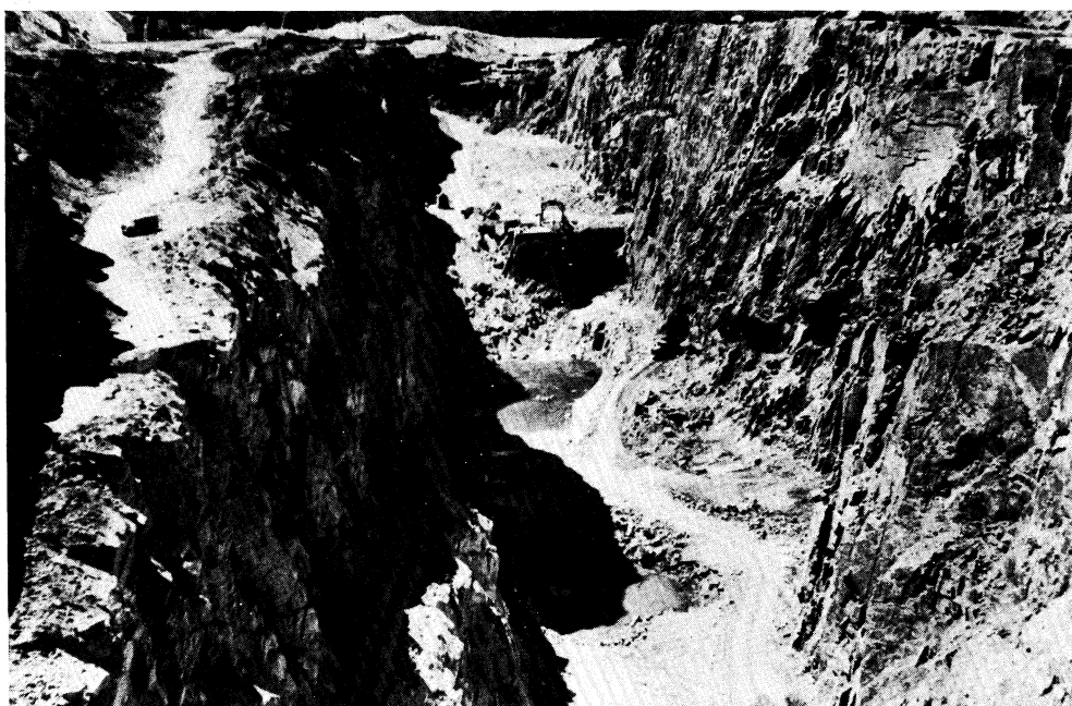
Foto n.º 6. Corta de Barruecopardo sobre un haz de filones de dirección NE y buzamiento fuerte al Este, mineralizados con Scheelita.
