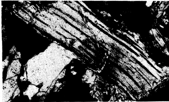
Fig 3.- A- Cristal de plagioclasia reemplazado parcialmente por Feldespato Potásico. B- Biotita, en parte, sustituida por moscovita con flexurización, "recovery" y recristalización en los bordes. C- Moscovita deutérica, flexada con "recuperación" y _ bordes recristalizados.
