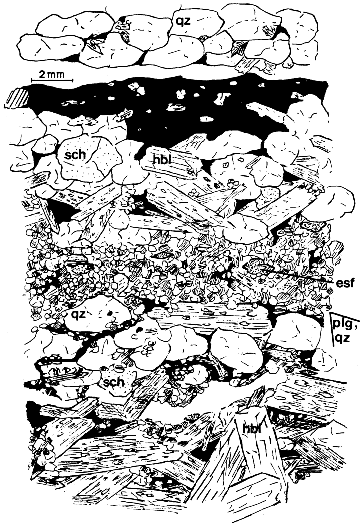
Fig. 3: Aspecto microscópico de la pizarra rica en anfíboles con scheelita (hbl-hornblenda, qz-cuarzo, plg-plagioclase, esf-esfena, sch-scheelita, XX negros: sulfuros).
