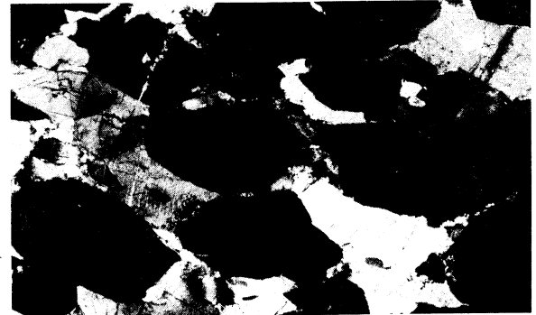
Pirigarnita granoblástica. Se observan los granos aplastados y frecuentemente con extinción ondulante. Nícoles cruzados X20.
