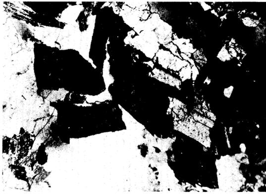
Fig. 18. (Go 28, NC, x 25). El cuarzo, tardío, suelda los fragmentos de un cristal de casiterita roto por los esfuerzos que acompañaron al emplazamiento del leucogranito albítico.
