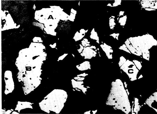
Fig. 15. (G, LN x 200) Aspecto del concentrado de niobio y tántalo, formado en este caso por granos de tantalita (A) con inclusiones de casiterita (B) y tapiólita (C).
