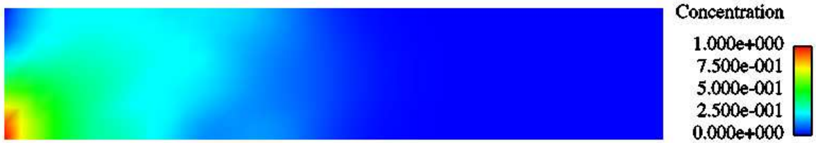
Figura 8: Flujo subcrítico en un canal. Solución para t = 3 s. usando Taylor-Galerkin de segundo orden.
