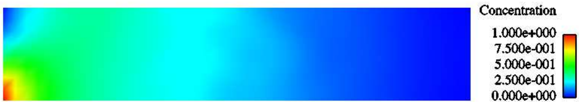
Figura 9: Flujo subcrítico en un canal. Solución para t = 6 s. usando Taylor-Galerkin de segundo orden.
