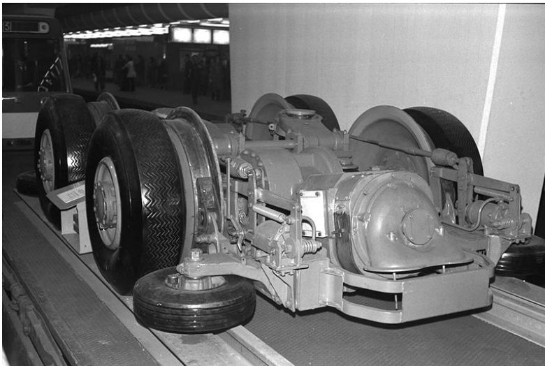
Figura 1.5. Bogie bimotor sobre neumáticos de un vehículo MP73 del Metro de París.
