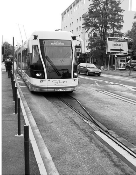
Figura 1.9. Entrada en una zona con carril de guiado del vehículo bimodal de Nancy.
