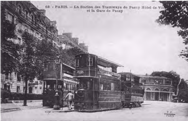
Figura 2.9. Tranvías con tracción por aire comprimido, en la estación de tranvías de Passy (París), hacia 1900.
