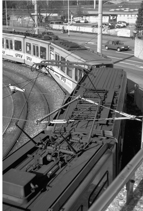
Figura 1.2. Tranvía en Hannover captando energía eléctrica (600 V cc) a partir de un hilo de contacto mediante pantógrafo.
