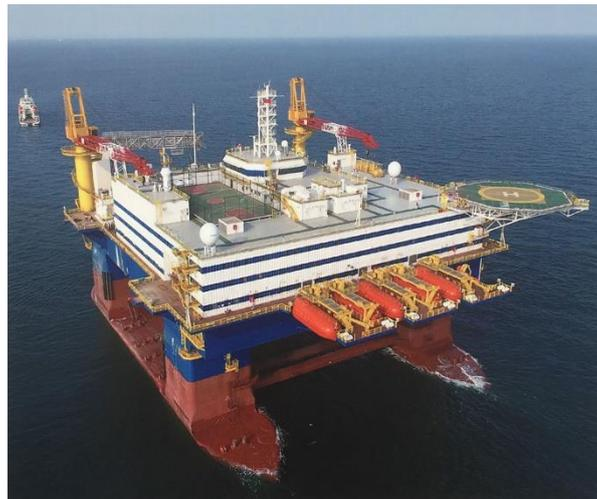
Figura 10 Plataforma semisumergible Serooskerke
