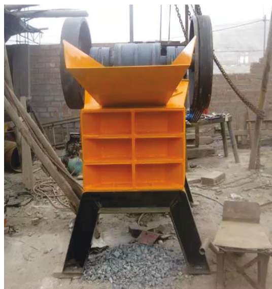
Figura 4.7. Máquina trituradora mejorada
