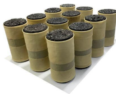
Figura 29 – Almacenamiento de las probetas de CRM en condiciones de sellado parcial
