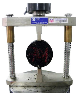
Figura 12 – Rotura según ensayo ITS
