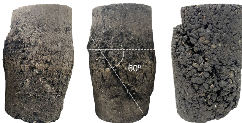
Figura 38 – Probetas tras ser sometidas a ensayos MTx. Inclínación del plano de rotura a aproximadamente 60 °
