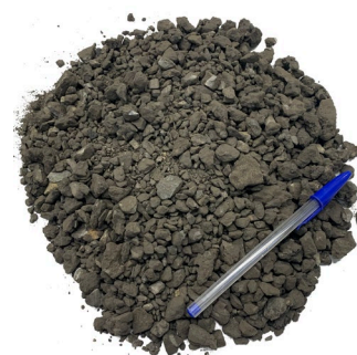
Figura 19 – RAP originario de A Coruña
