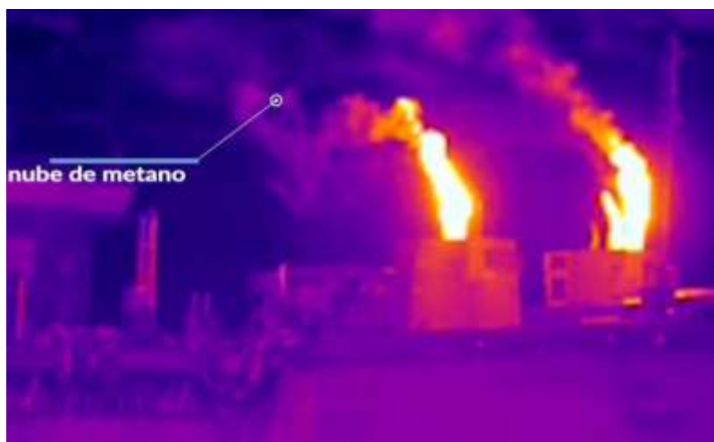
Figura 5.1.1.- Emisións de calor e gas metano das chimeneas de escape dos motores de dous buques. Fonte: transportenvironment.org
