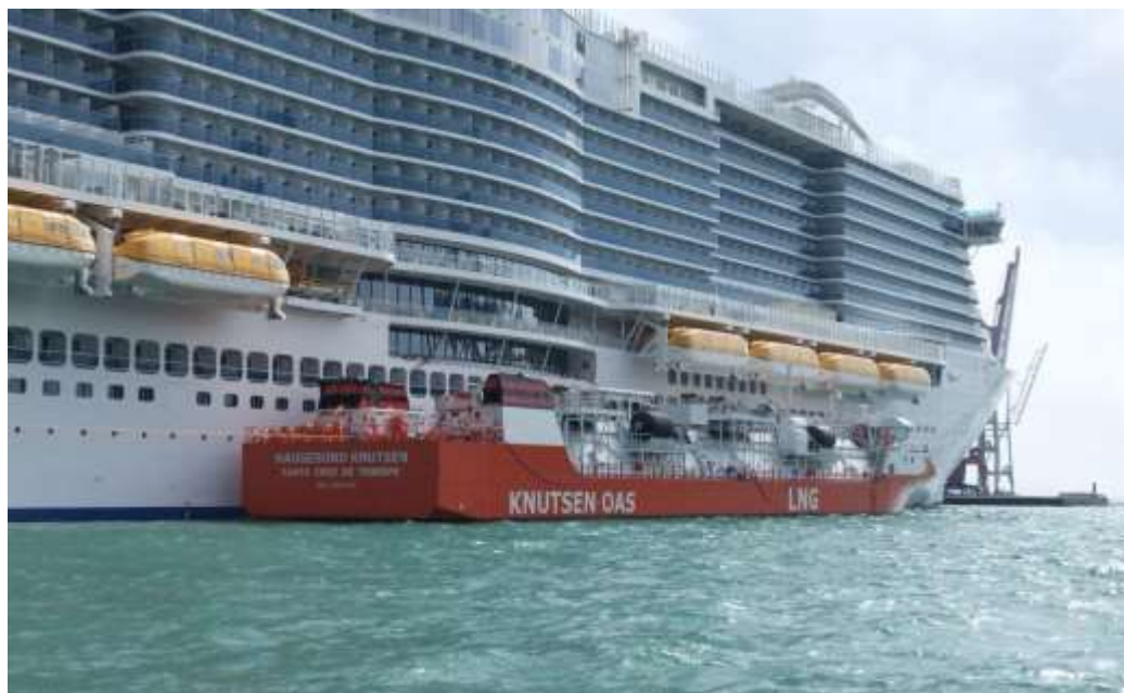
Figura 6.2.- Primeiro suministro STS do buque Haugesund Knutsen. Abarloado por estribor ao cruceiro italiano Costa Esmeralda. Fonte: Knutsen Group
