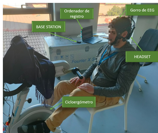
Figura 2: Montaje de los experimentos realizados. Sujeto de pruebas realizando una de las sesiones de registro de señales EEG. Las señales se capturan mientras pedalea y ejecuta las tareas mentales. Se tapó la pantalla interactiva del cicloergómetro para evitar estímulos externos al protocolo de registro.
