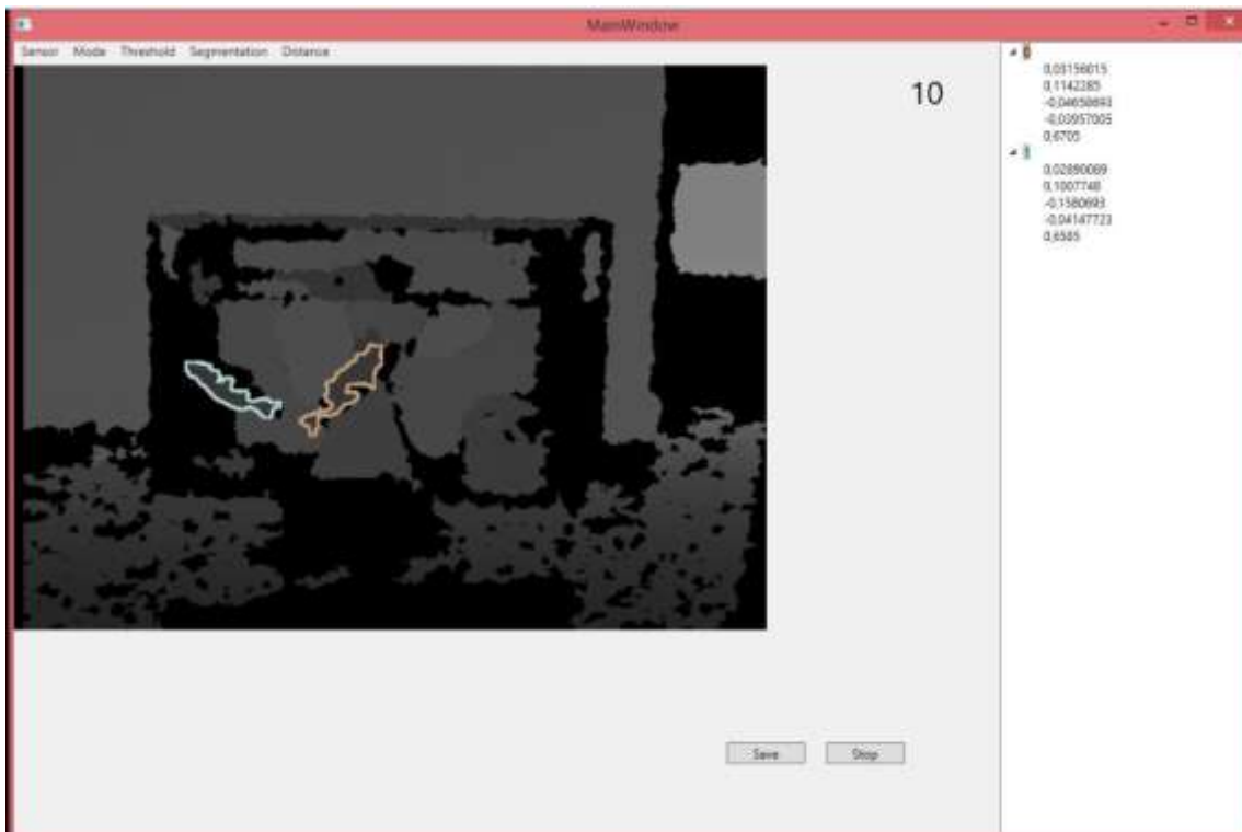
Figura 75: Ejemplo de pantalla con la detección de 2 peces y la obtención de su tamaño.
