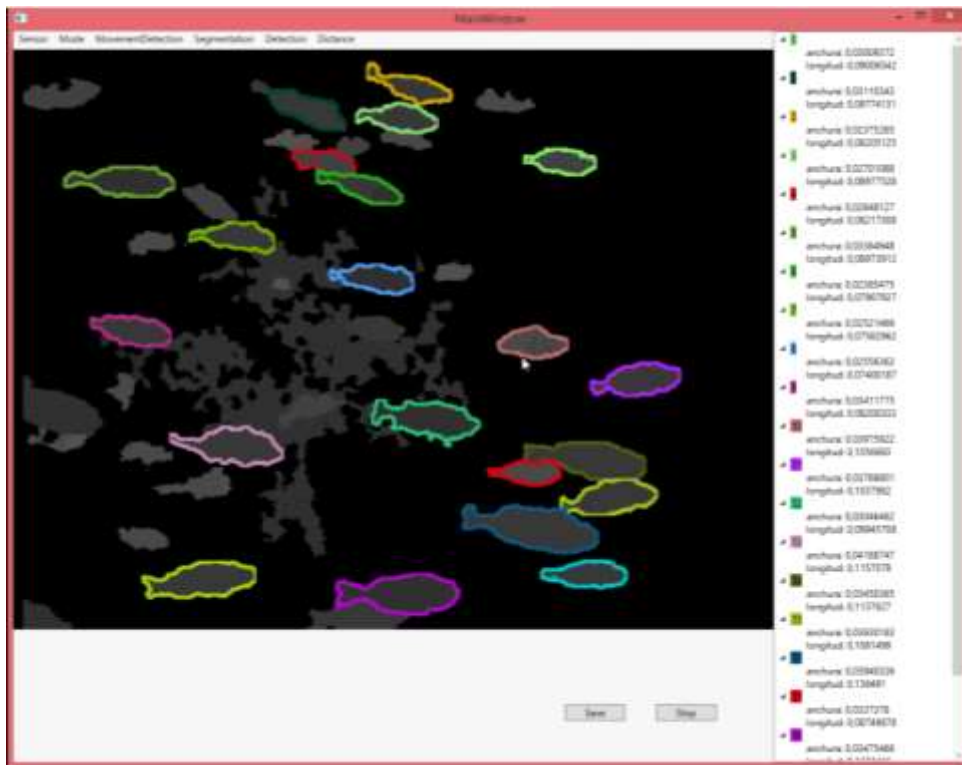
Figura 83: Ejemplo de detección en la herramienta en un tanque con peces reales
