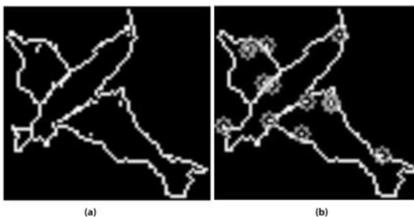
Figura 64: Detección de bordes (a) máscara de bordes, (b) puntos seleccionados para la unión de bordes
