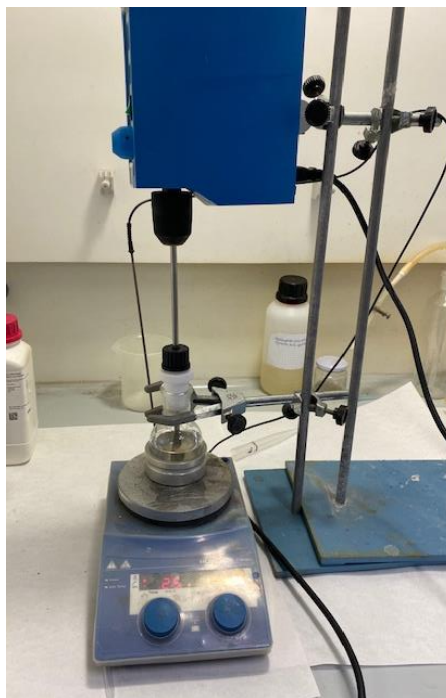
Figura 4. Montaje realizado para la síntesis de los MIPs.
