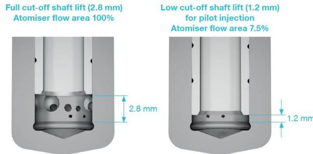
Figura 6.1.4.2. Nuevo diseño de tobera para distintos modos del motor MAN B&W ME-GI. [62]
