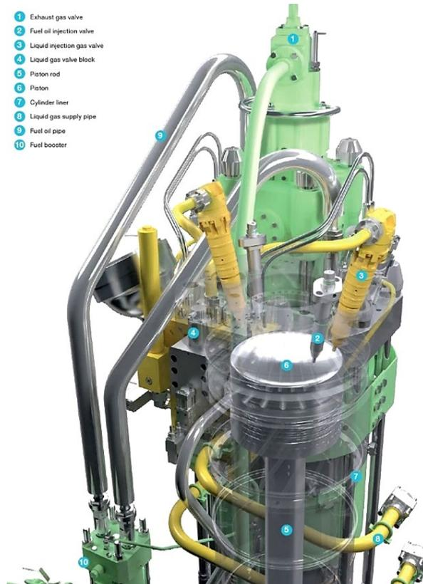
Figura 6.2.1. Elementos de inyección del motor MAN B&W LGI. [69].
