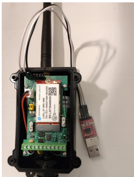
Figura 25. Conexión del conversor USB-TTL al dispositivo LSPH01. Fuente: Elaboración propia.
