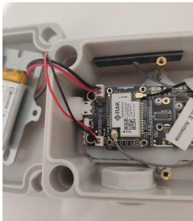
Figura 32. Conexión de la batería y placa solar a RAK5005-O. Fuente: Elaboración propia.
