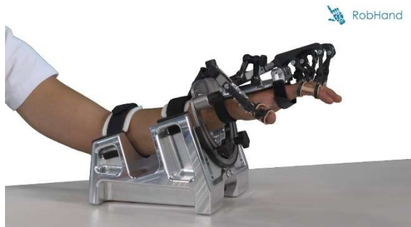
Figura 1. Exoesqueleto de mano RobHand
