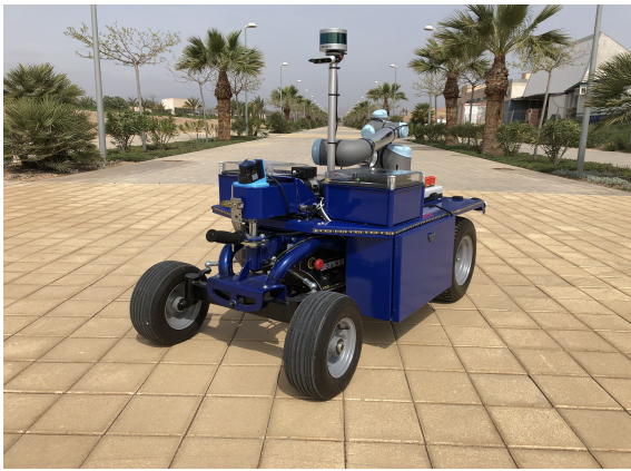
Figura 6: BLUE: roBot for Localization in Unstructured Environments adecuado para manipulación y navegación autónoma en entornos exteriores no estructurados.
