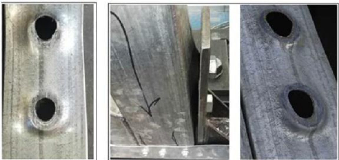
Figura 61. Detalles de la deformación de los agujeros en la viga de sección cuadrada. Ensayo experimental. (Fuente: [2] “ Lateral performance of a new hybrid CFS shear wall panel for mid-rise construction ”)
