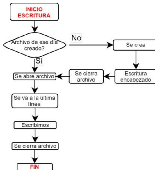
Figura 8.29 – Flujograma de la función para el guardado de los datos en CSV.
