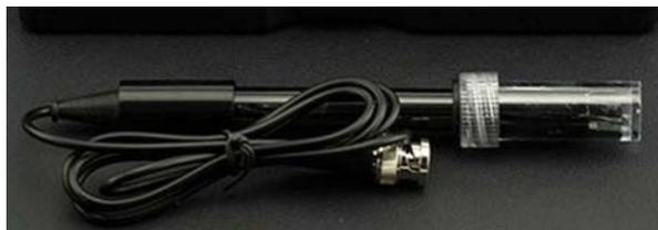
**Figura 8.4** – Aspecto del sensor de potencial redox [9].
