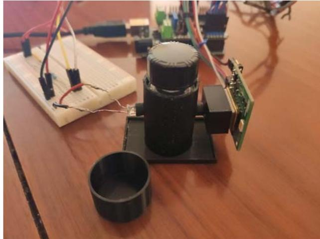
Figura 8.11 – Implementación física del encapsulado diseñado.
