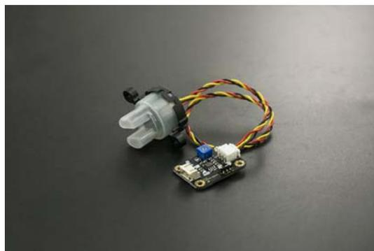
**Figura 8.1** – Aspecto del sensor de turbidez junto con su placa de acondicionamiento [6].
