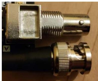
**Figura 8.19** – Conector tipo BNC.
