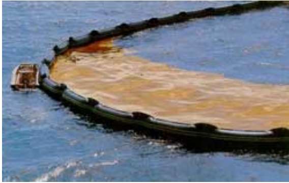
Figura 1: Imagen de una barrera de contención de vertidos desplegada en altamar
