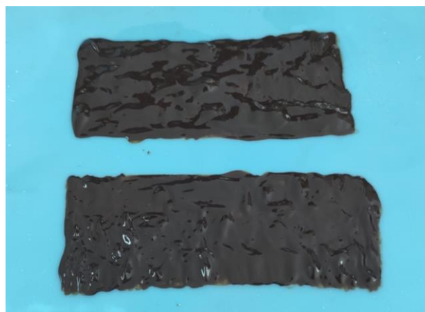
Figura 15. Láminas formadas del bioplástico lignocelulósico.
