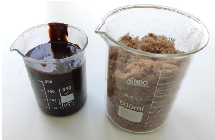
Figura 9. Adhesivo acetilado y fibras empleados para la formación del material compuesto.
