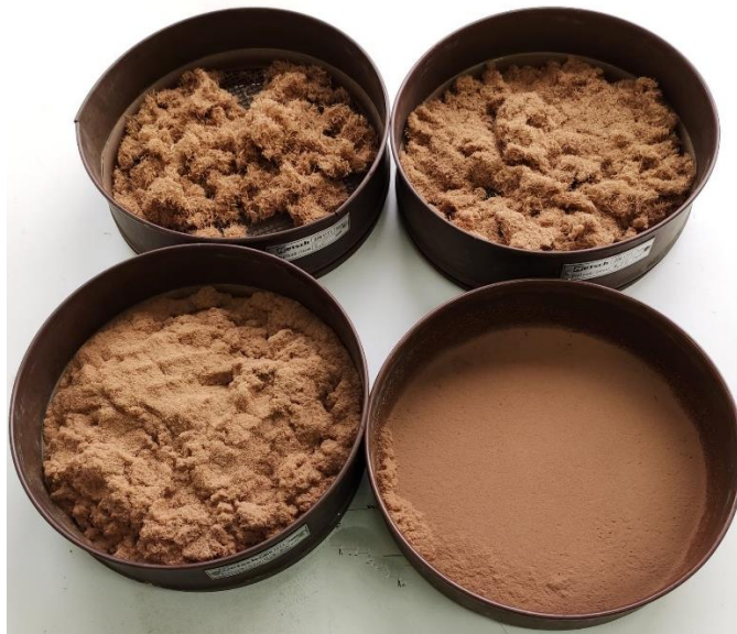
Figura 11. Tamices empleados para la separación de las fibras.
