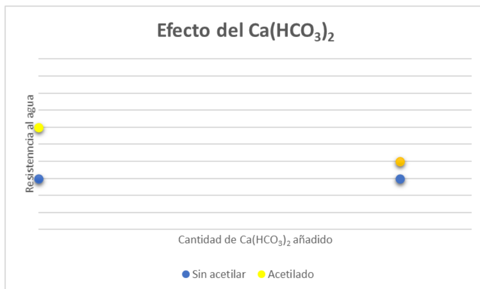
Gráfica 8. Estudio de la resistencia al agua del material compuesto acetilado y sin acetilar en presencia de \text{Ca}(\text{HCO}_3)_2 .
