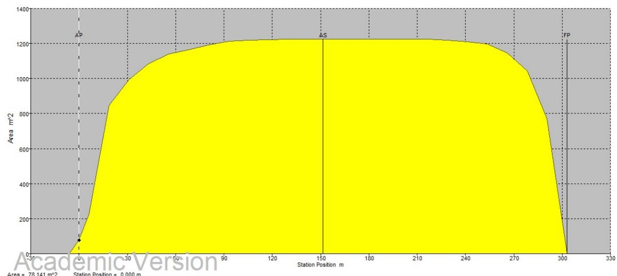
En la curva de áreas se puede comprobar la predominancia del cuerpo cilíndrico sobre los cuerpos de entrada o salida del buque a proyectar. Además, y cumpliendo con uno de los atributos que caracterizan a los petroleros, se comprueba la obtención de unas formas llenas.
