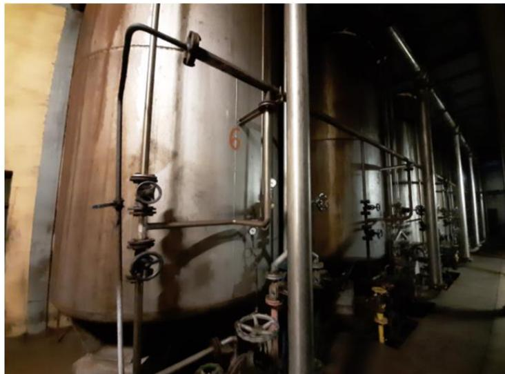
**Figura 2.4:** Tanques de Decantación de Aceite-Hexano
