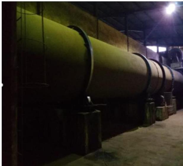
**Figura 2.3:** Secador de Bagazo
