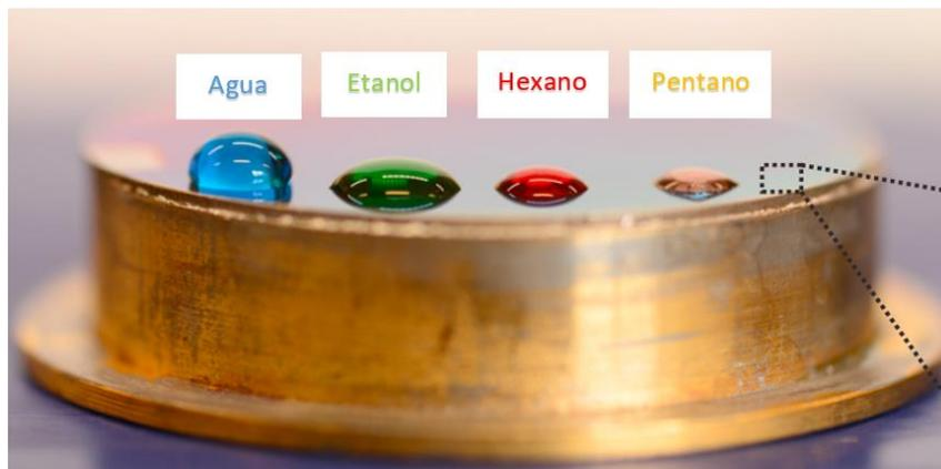
**Figura 2.1:** Fotografía de gotas de una variedad de líquidos y agua de baja tensión superficial que descansan sobre un disco metálico recubierto con iCVD. [4]
