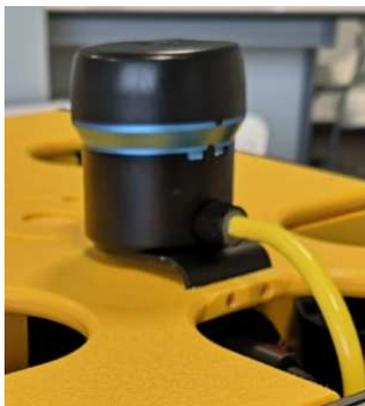
Figura 6: Ping360 sobre el ROV.
