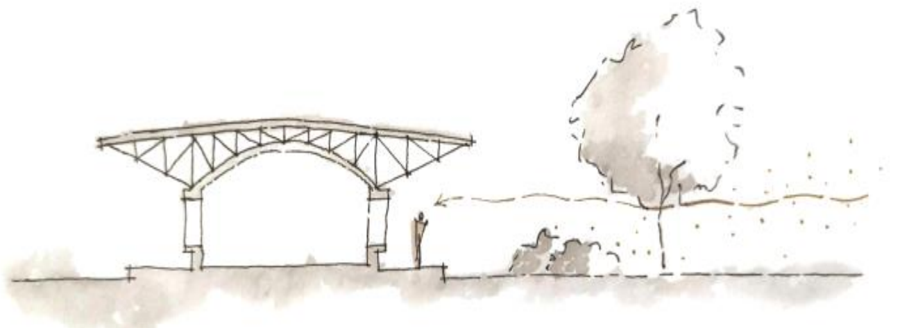
Fig 5.29 Barrera vegetal. Esquema en sección de filtrado del viento y el polvo. Elaboración propia.
