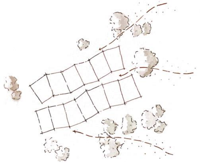
Fig 5.28 Barrera vegetal. Esquema en planta de filtrado del viento y el polvo. Elaboración propia.
