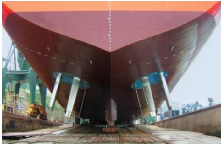
Colocación habitual sistema de propulsión Voith Schneider
