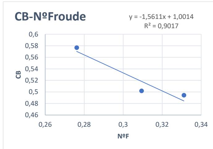
Con dicha ecuación obtenida a través de la regresión, obtenemos el coeficiente de bloque de nuestro buque.
