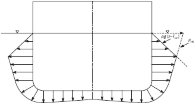
Se considera la condición dinámica HSM-2 maximizando el momento flector por las olas en la parte del buque y z será menor que  $T_{LC}$  por estar en el fondo:
