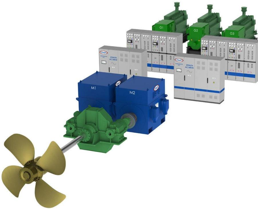
En el esquema se ve como la energía eléctrica producida en los generadores diésel se distribuye mediante el correspondiente cableado a los motores eléctricos. En este recorrido nos encontramos con dispositivos electrónicos que se encargan del control de los parámetros de funcionamiento de estos motores como pueden ser los transformadores, convertidores de frecuencia, etc.
