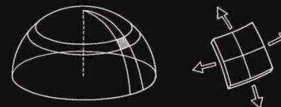
Transmisión de cargas en membranas en forma de cúpula bajo una carga simétrica
