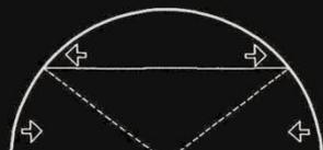
La continuidad horizontal (anular) se opone a la deformación; la parte superior se comporta como una sucesión de anillos comprimidos y la parte inferior como una sucesión de anillos a tracción.
