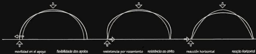
En el caso de apoyos deslizantes, se puede dilatar libremente el borde de la membrana: tensiones puras de membrana. En cambio, al movimiento se limita debido al rozamiento en los apoyos, aparecen perturbaciones de flexión. Igual sucede en el caso de que la tangente en el punto de apoyo no sea vertical y se coloque un anillo inferior de rigidización que se deforme de manera diferente al resto de la membrana.
