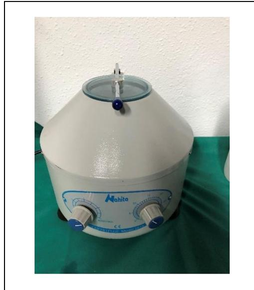
(Fig.6): Se centrifuga la sangre obtenida a 3000 rpm durante 10 min.
