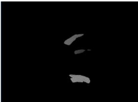
Figura 4. Imagen en la que mediante un filtro de color, se han eliminado todos aquellos elementos que no correspondan a los dedos. Esto permite disminuir significativamente el número elementos en la nube de puntos y trabajar con componentes conexas que aproximaremos a cilindros.
