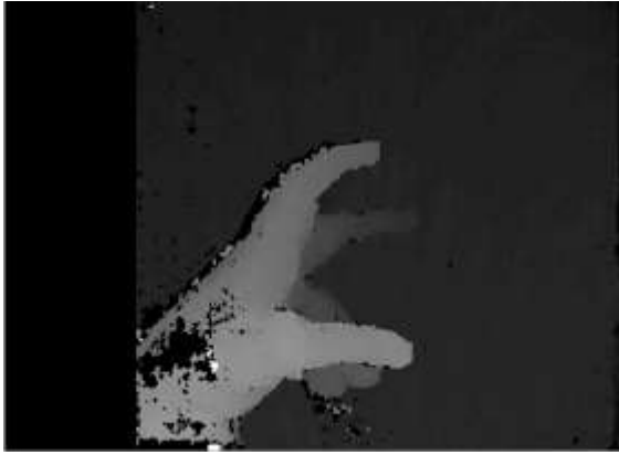
Figura 3. Mapa de disparidad obtenido para el par correspondiente a la imagen de la figura 1. Las zonas más claras indican una mayor proximidad a la cámara.
