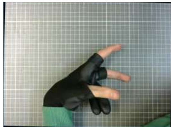
Figura 2. Imagen original. Corresponde a la imagen capturada por una de las cámaras del sistema de visión estereoscópico. La mano aparece cubierta por un guante sensorizado que proporcionará datos sobre la flexión y movimiento de los dedos.
