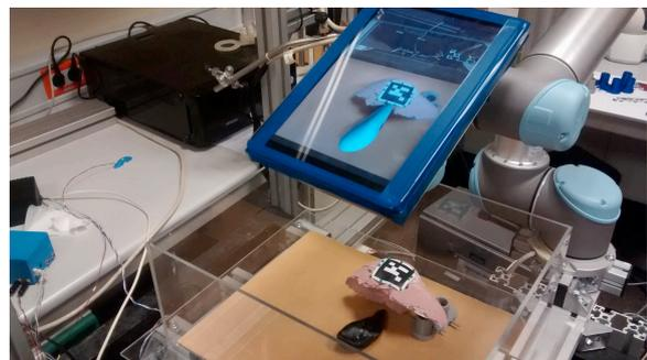
Figura 5: Fotografía de montaje con el dispositivo de despliegue y marcador físico ubicado en el hígado sintético
