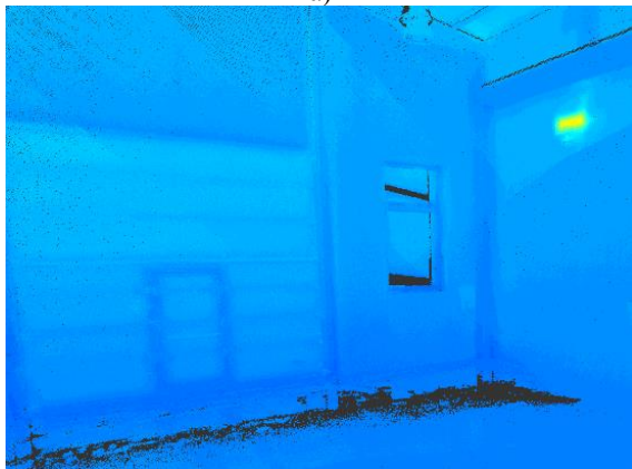
Figura 12. a) Imagen la nube de puntos térmica en una de las salas del edificio. Se aprecia variación de temperatura en distintos componentes del edificio y salidas calientes de aire. b) Detalle de variación de temperatura en la parte inferior de las paredes.
