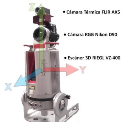
Figura 1: Imagen del sistema 3D T-Scan. Se ilustra el sistema de coordenadas universal utilizado.
