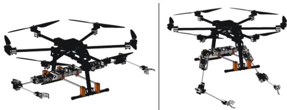
Figura 5: Posición de despegue/aterriaje (izquierda) y posición de operación (derecha).
