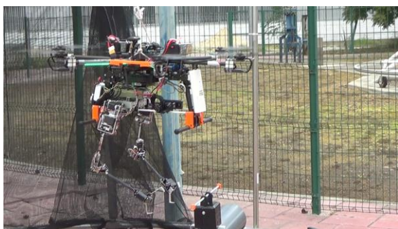
Figura 1: Manipulador aéreo bi-brazo realizando una operación de agarre en vuelo.
