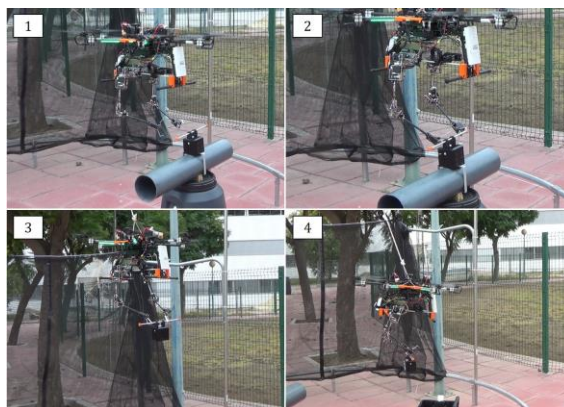
Figura 11: Experimento de agarre: aproximación (1), agarre (2), recuperación (4) y transporte (4).
